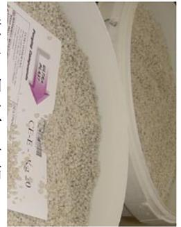
**清洗料的准备：** 清洗料是将 ECO-CE-CS 和你的合适的生产用塑料粒子（可能的话用熔指<0.1 的高粘度 HDPE 粒子）按 5%的 ECO-CE-CS 与 95%的塑料粒子混合而成（注意：不要使用超过指导使用比例的 ECO-CE-CS）。
