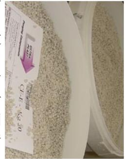
**清洗料的准备:** 清洗料是将 CE-CS 和你的合适的生产用塑料粒子 (可能的话用熔指<0.1 的高粘度 HDPE 粒子) 按 8-10% 的 CE-CS 与 90-92% 的塑料粒子混合而成 (**注意: 不要使用超过指导使用比例的 CE-CS**)。
